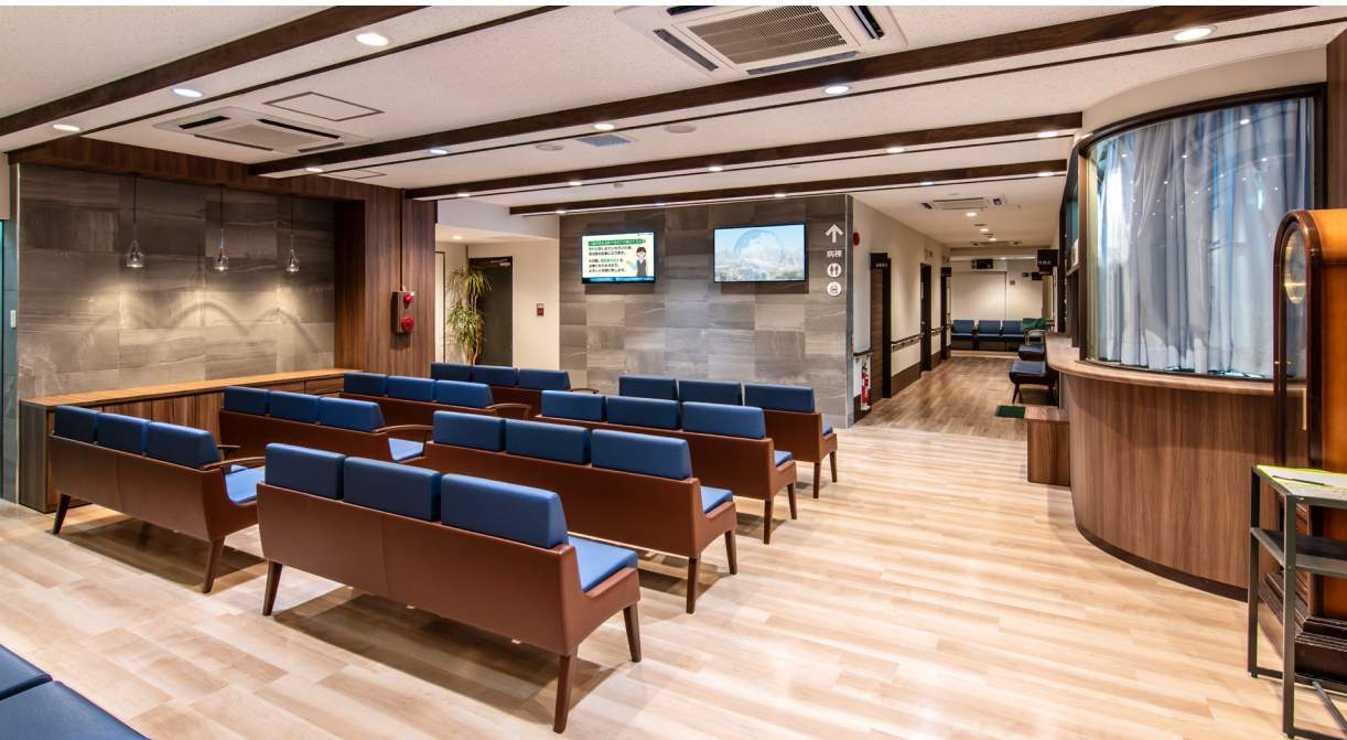
天井の圧迫感がでないようウォールナットを4本のみアクセントとして入れ照明を増設。掲示物を整理し、新たにデジタルサイネージ(院内広報物を放送)を設置。
